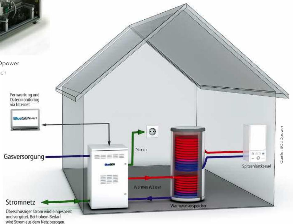
Schema „BlueGen“ - Einbindung in die Hausenergieversorgung
