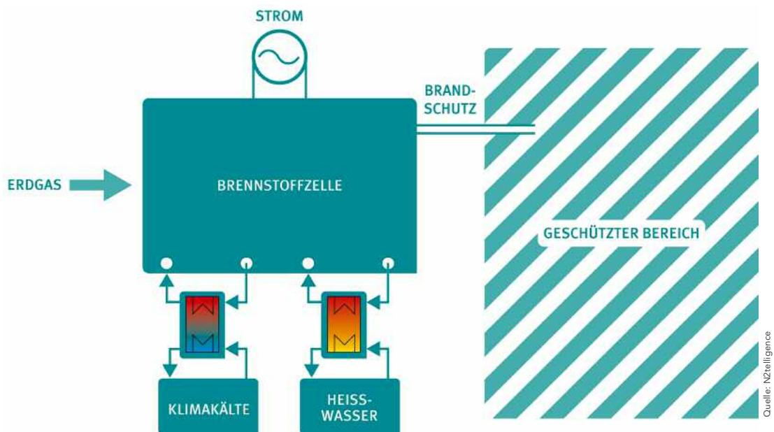
Schema der Quattro-Generation BZ-Anlage von N2telligence
