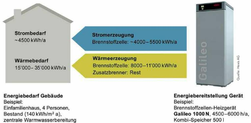
Bedarfsgerechte Energieerzeugung durch ein Brennstoffzellenheizgerät im Wohngebäude, Beispiel SOFC-Heizgerät Galileo von Hexis
